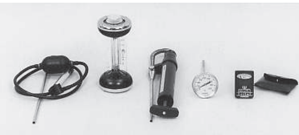
Einfache Messgeräte zur Bestimmung von Russ- und CO 2 -Gehalt Appareils rudimentaires pour la détermination des gris de suie et le CO 2 Strumenti di misurazione per la determinazione del tenore dei fuliggine e CO 2
